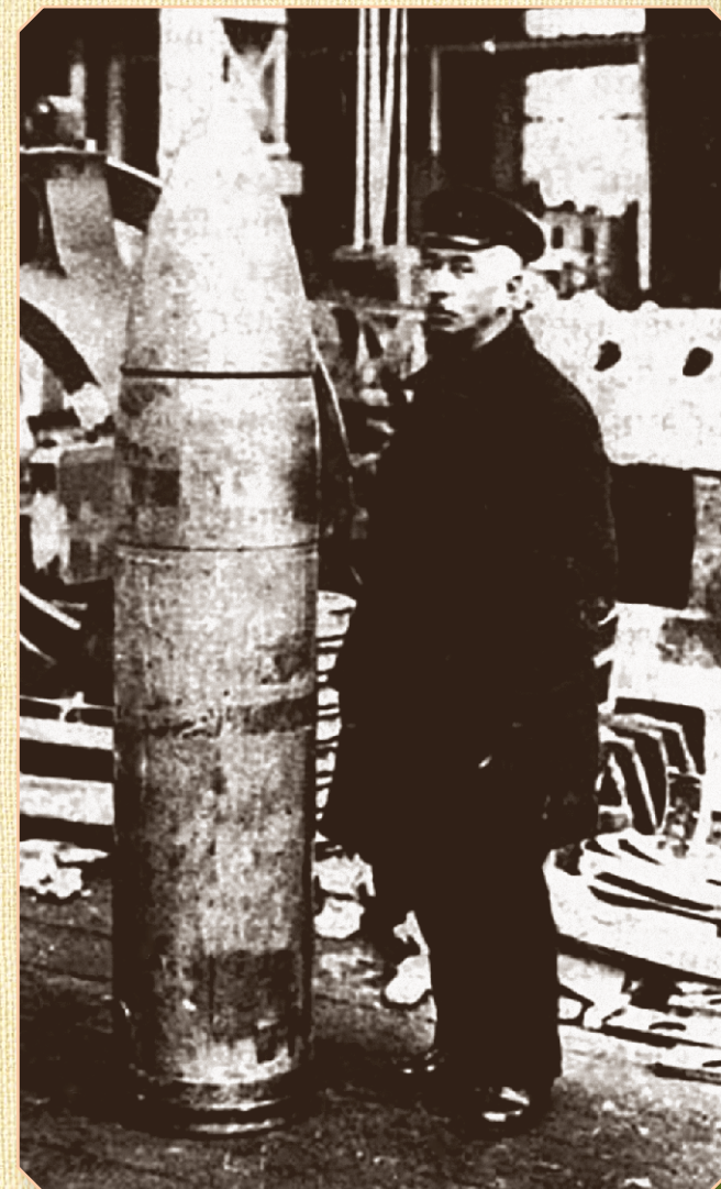
Фугасный снаряд к 356-мм пушке установки ТМ-1-14
